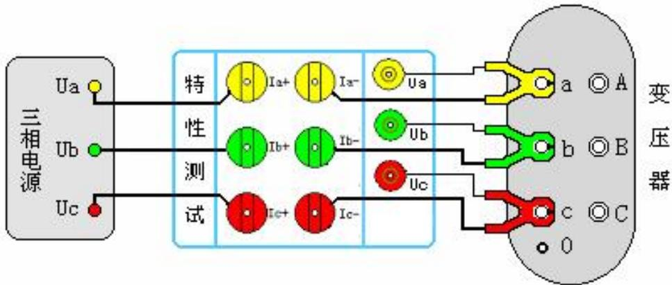
图 10、三相电源测量变压器空载损耗
