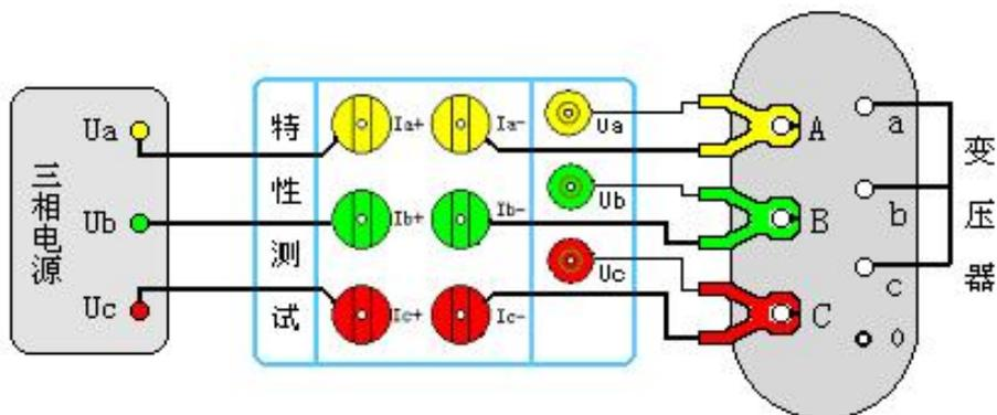
图 7、三相电源测量变压器短路损耗
