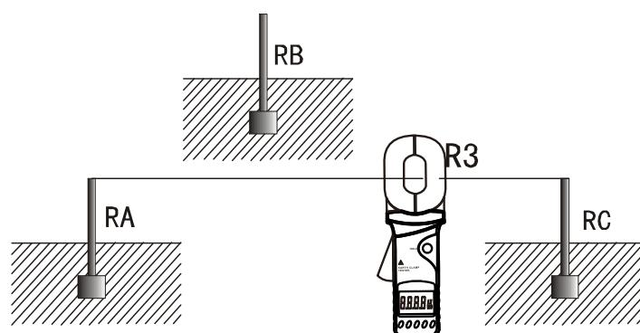
上面三步中，每一步所测得的读数都是两个接地电阻的串联值。这样，就可以很容易地计算出每一个接地电阻值：
