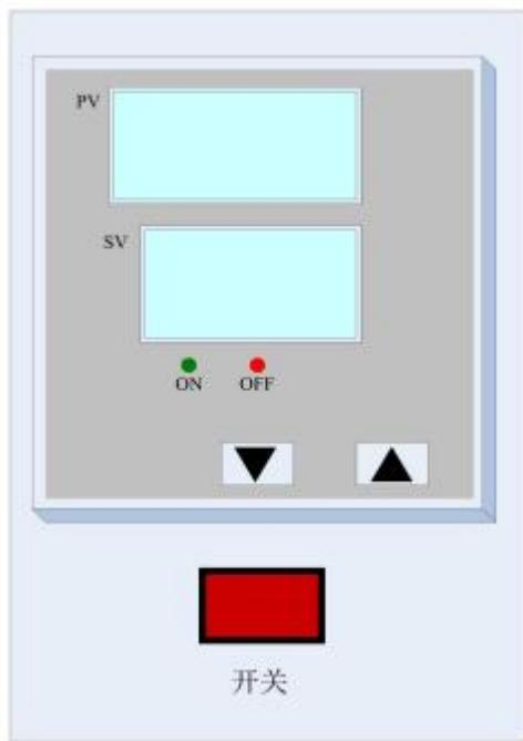
图 4.1 恒温干燥箱面板
